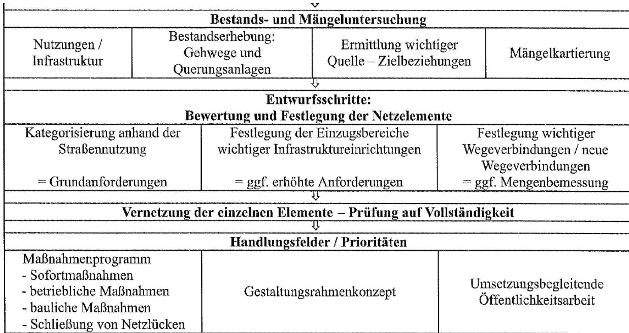
Bild 1: Arbeitsschritte zur Entwurfsbearbeitung
